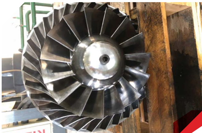
Quạt máy nén khí cao áp nhà máy Thép
