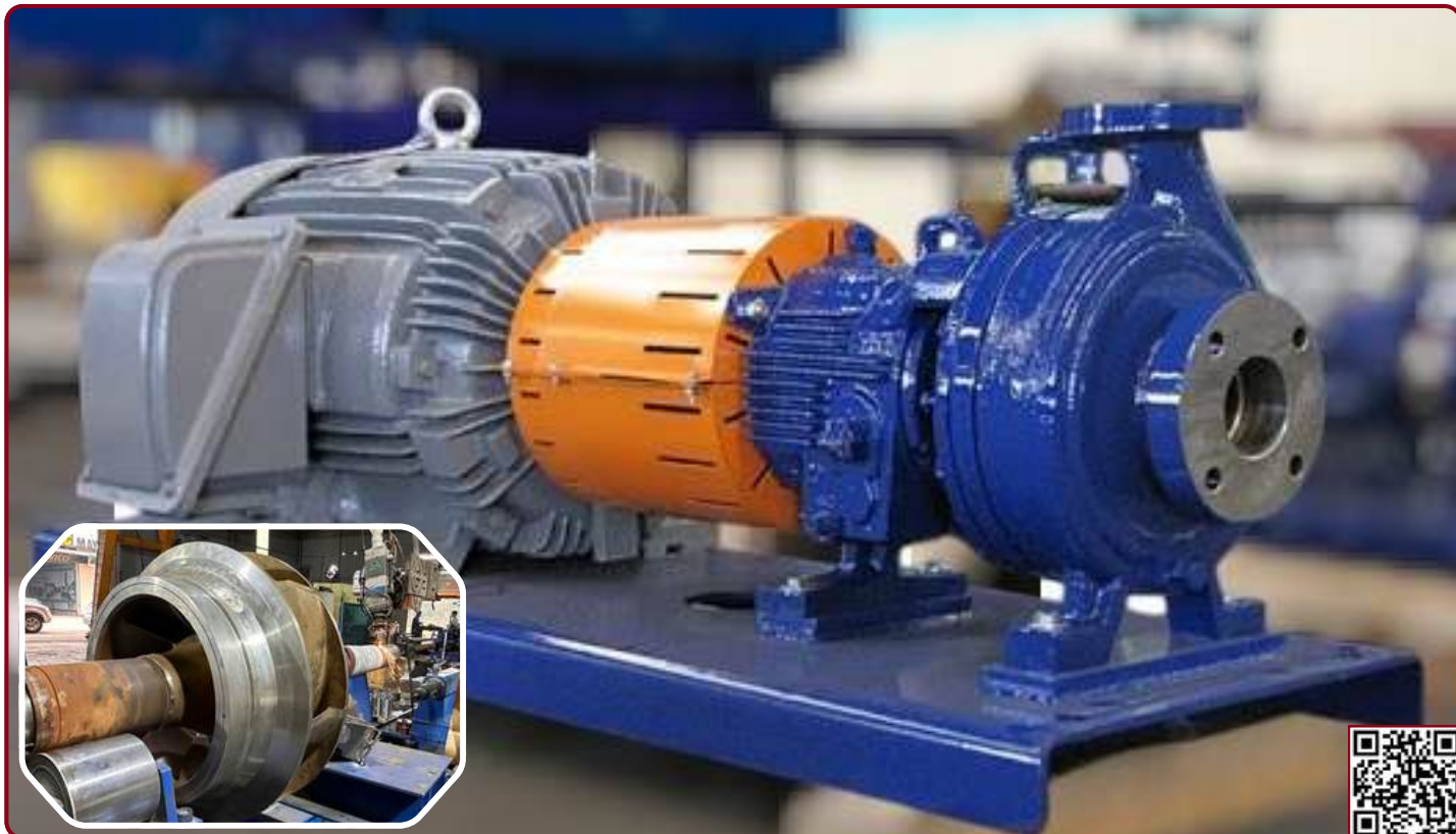
Bơm cấp nước nhà máy nhiệt điện
