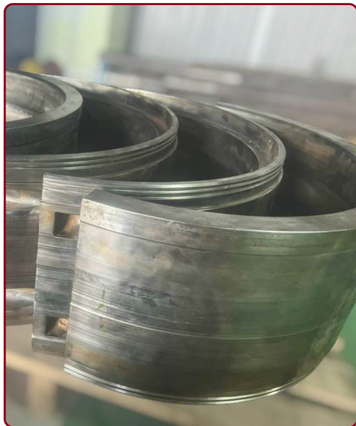
Bạc trục thủy điện
