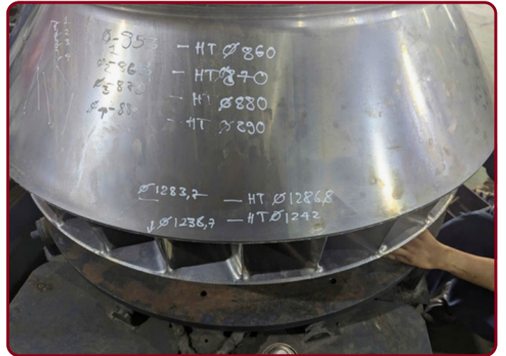
Bánh xe công tác 7.5 MW - Thủy điện Chí Lư
