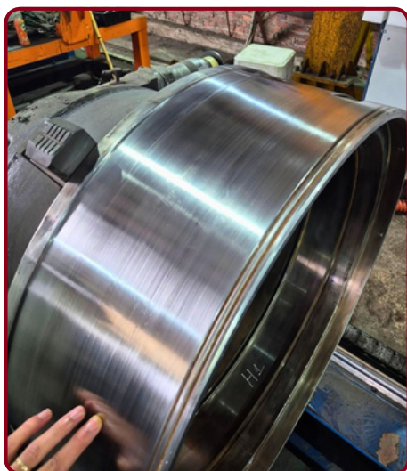
Bề mặt trước và sau khi phục hồi - Thủy điện Nậm Lức
