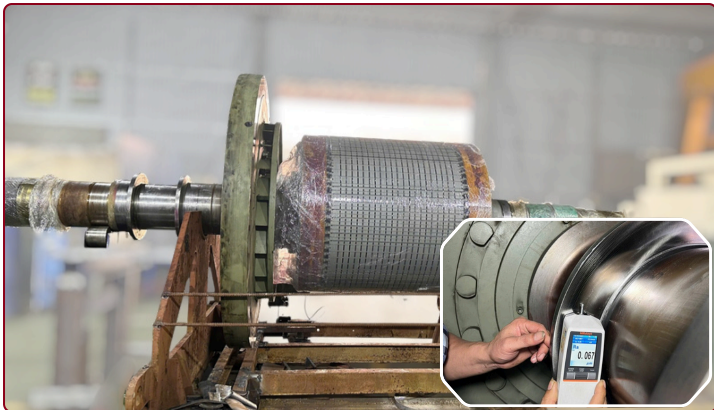
Phục hồi mặt gương Rotor máy phát - Đối tác Viện Cơ Khí
