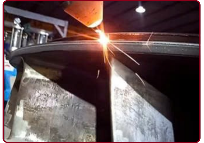
Bánh xe công tác 4MW- Đối tác Viện Cơ Khí
