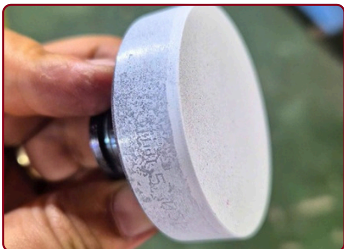
Nám Babbitt máy phát 4706 KVA- Thủy điện Nậm Lùm
